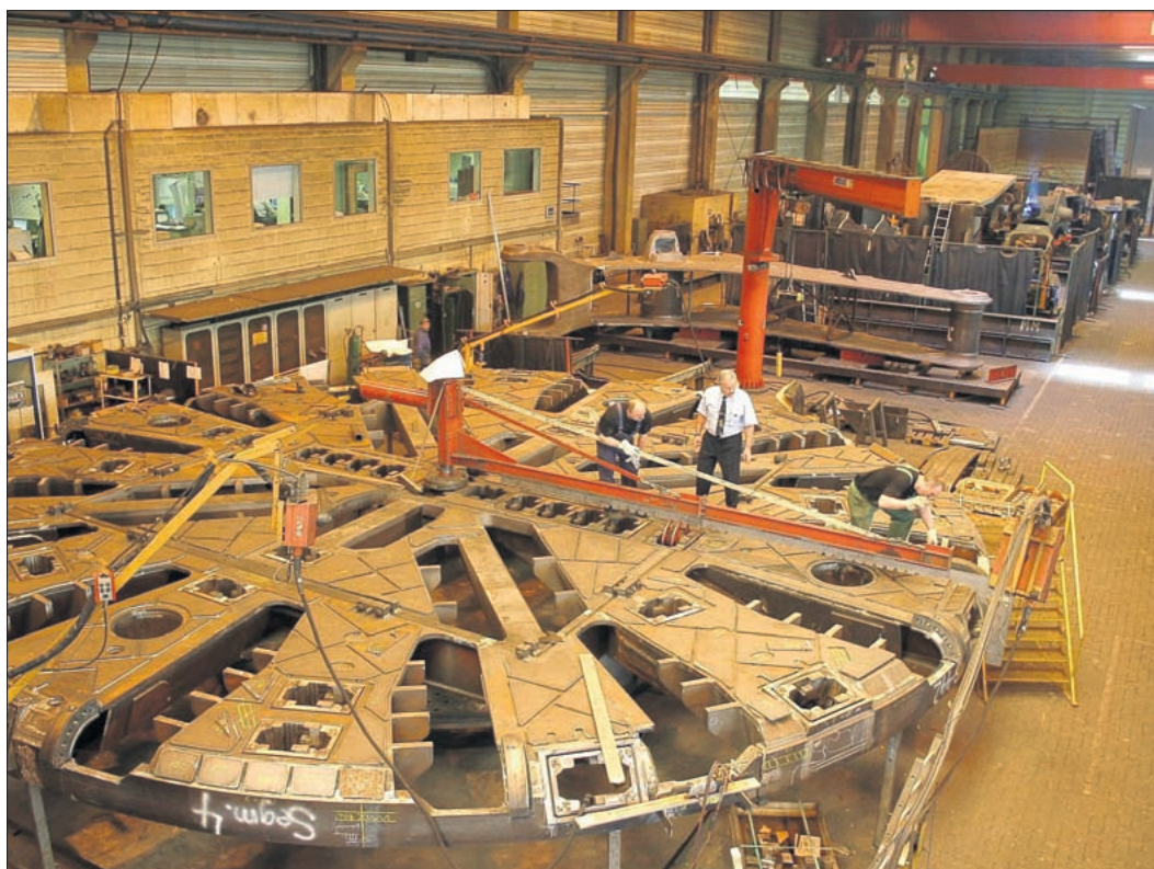
Etwas mehr als 13 Meter beträgt der Durchmesser dieses Bohrkopfes, der nach seiner Fertigstellung zum Tunnelbau in Zentralspanien eingesetzt werden soll. Firmenchef Axel Richter (helles Hemd) macht sich ein Bild vom Fortgang der Arbeiten. Fotos: Dieter Salzmann
